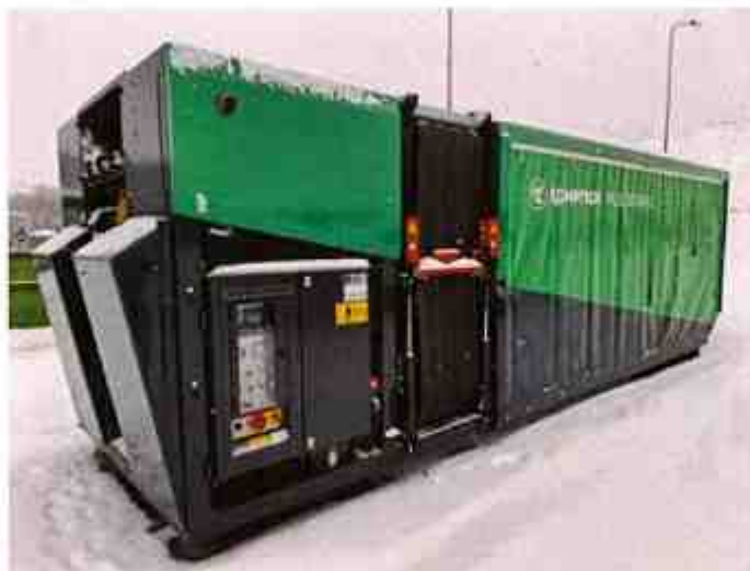
35 pav. Įsigytas žvaigždinis sijotuvus su oriniu separatoriumi
