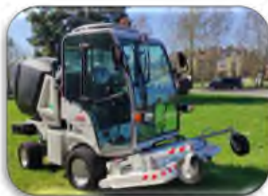
4. pav. Daugiafunkcinis mechanizmas „MATRA“ lapų surinkimui
