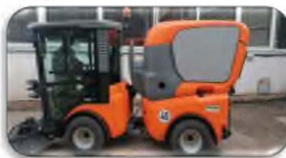
1 pav. Šaligatvių valymo 0,9 m 3 bunkerio talpos automobilis KARCHER MC 130
