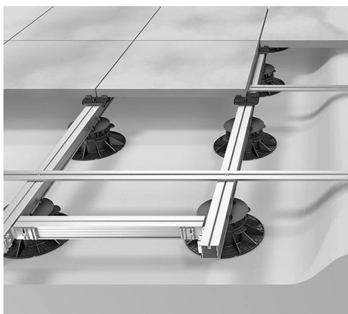
5 pav., 6 pav. Pakeltos konstrukcijos principinis sprendinys, terasos dangos pavizdys
