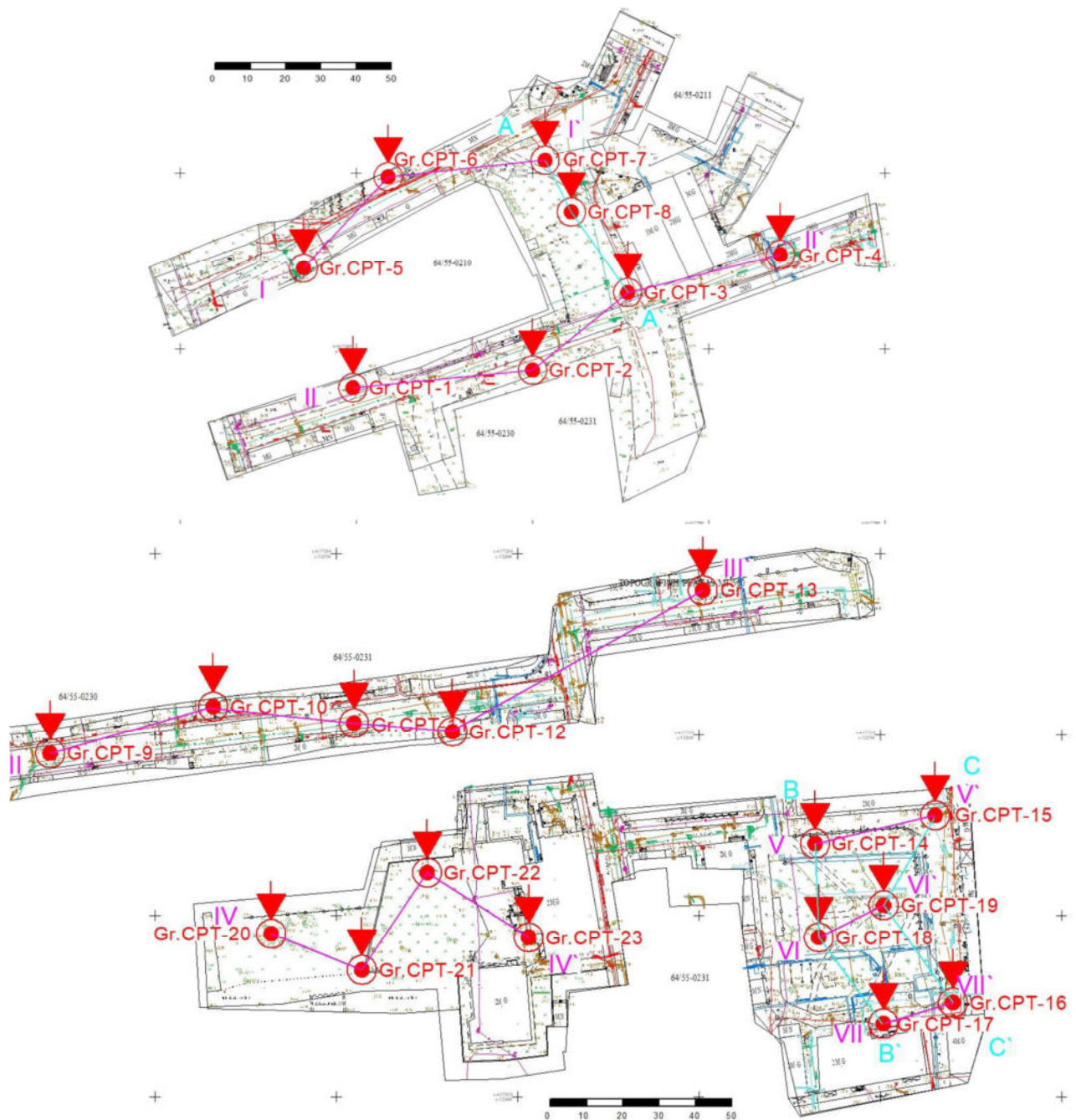
2 pav. Planas su lauko darbų tyrimų vietoms ir inžinerinių geologinių pjūvių linijomis
