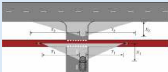
3 pav. Motorinės transporto priemonės, kertančios pagrindinį kelią ar gatvę ir (arba) dviračių trasą, vairuotojo matymo laukas
