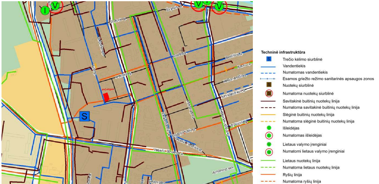
6 pav. Vandentvarkos inžinerinės infrastruktūros brėžinio fragmentas
