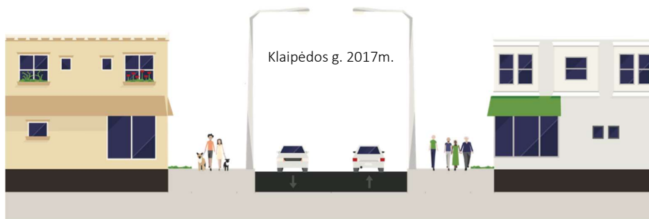
Pav. 20. Dabartinis Klaipėdos gatvės profilis: važiuojamoji dalis ir šaligatvis. Nėra dviračių tako.
