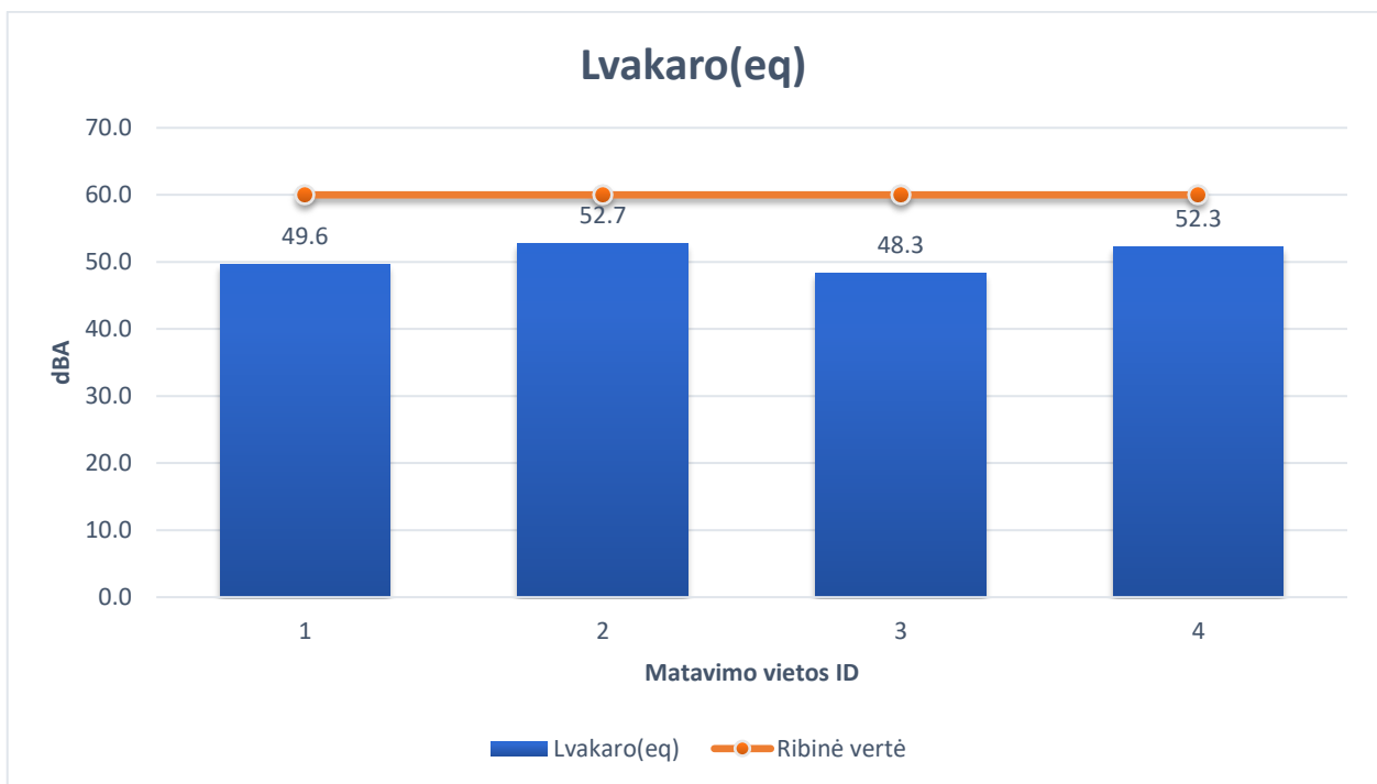
6 pav. Ekvivalentinio triukšmo pasiskirstymas matavimo vietose vakaro metu (19-22 val.). Ribinis dydis 60 dBA
